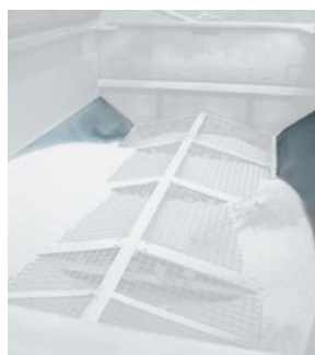
Бункер из нержавеющей стали 8 м 3
