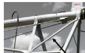
высокая жесткость конструкции (укрепление диагональными распорками)
