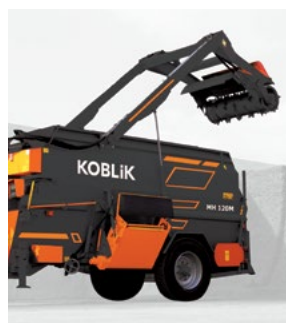
Загрузка силоса корма в смесительном бункере
