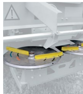
Разбрасывающие тарелки (ширина распределения)
