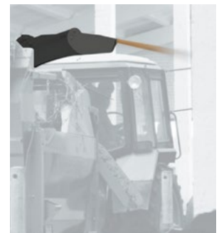
Выдувной желоб для управления вектором выдачи
