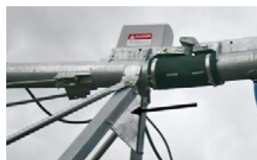
скрепляющая пластина, обеспечивающая большую проходимость по уклонам
