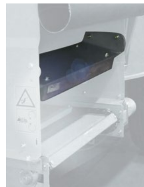
Магнитный улавливатель металлических предметов
