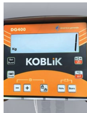
Весовой индикатор модели DG 400 на всех кормораздатчиках серии MV
