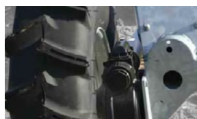
удобная очистка и обслуживание благодаря зазору между шиной и редуктором
