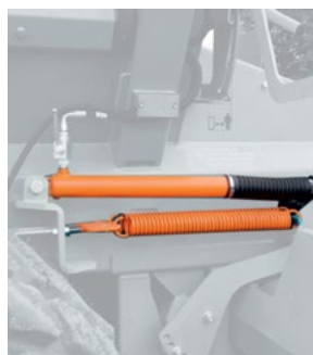
Гидроцилиндры управления привода транспортера
