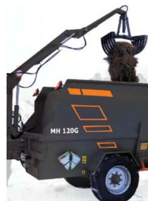
Угол поворота грейфера -240° без доворота машины
