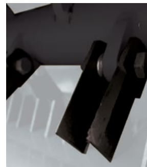
Фрезерный и бильный барабаны для качественного измельчения
