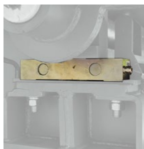
Весовая система для контроля перегруза
