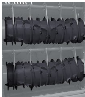
Измельчающий фрезерный барабан оснащен брусом с ножами
