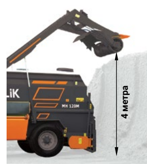
Высота подъема фрезы до 4 метров
