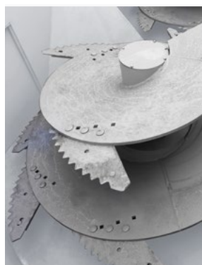
Два вертикальных конусообразных шнека
