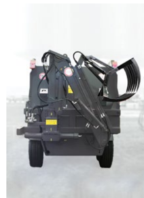
Грейфер не выходит за габариты кормораздатчика
