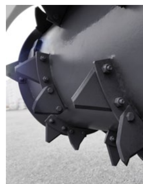
Загрузочный фрезерный барабан модели MV 140 M
